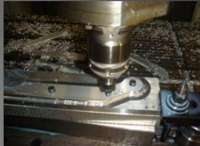
Este es el torno, equipo que ha diseñado mi actual base, notar como además del rebaje de la pieza que originalmente no es mas que un taco rectangular de aluminio, la misma maquina impresiona el logotipo de la casa con total delicadeza y precisión
