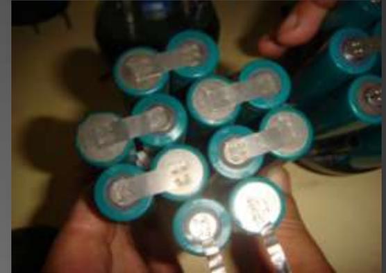
A la izquierda los paquetes de baterías en la mesa de TESTS. En el centro un paquete de baterías con las conexiones que la empresa considera validas para sus productos. A la derecha las soldaduras y conexiones que aunque funcionando igual que las anteriores no tienen la calidad que la marca exige. (Fijaros en el detalle de la soldadura entre baterías)
