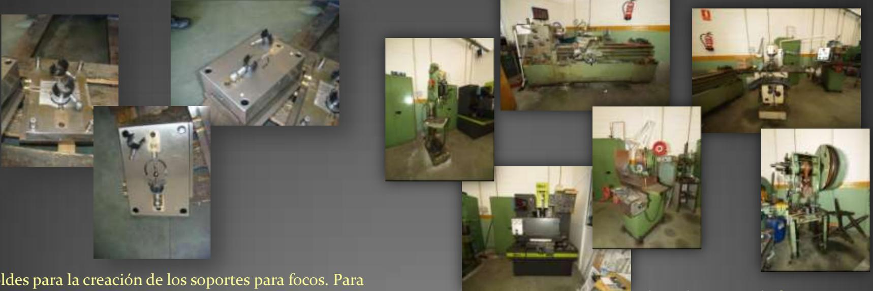
Moldes para la creación de los soportes para focos. Para mover estas piezas que no harán mas de 50cm, hay que utilizar un toro debido al peso del molde en sí.
