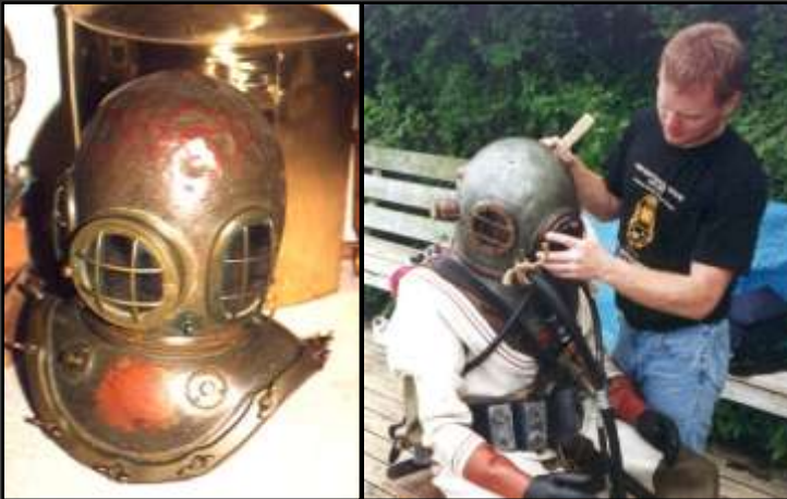
UNO DE LOS PRIMEROS CASCOS Siebe, del año 1830, ilustra las 3 mirillas normales del casco (izquierda). El casco (derecha) muestra la válvula de purga trasera y la rosca en la mirilla facial.
