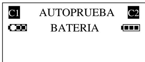
Las Baterías se comprueban mientras el Solenoide inyecta y el voltaje de la batería se refleja en los iconos.
