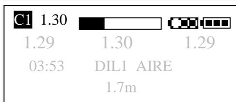
La lectura del absorbente simplemente muestra la parte activa del absorbente. El monitor comienza vacío y cuando el fondo del absorbente empieza a calentarse, la parte izquierda de la pantalla empieza a ponerse negra, seguida por el siguiente segmento y así progresando a través de la pantalla del absorbente de izquierda a derecha.
