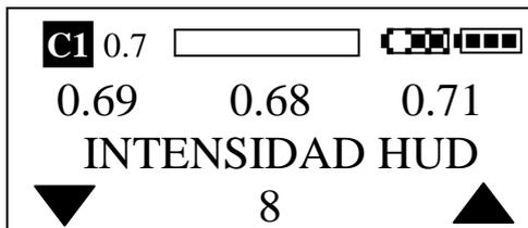
La INTENSIDAD de los LEDs del Head Up Display puede ajustarse para ajustarse a la luz ambiente. Una inmersión nocturna requiere una menor INTENSIDAD. El rango de ajuste esta de 1 a10.
