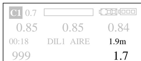
La Profundidad máxima se muestra aquí como 1.9m y la Profundidad actual, 1.7m, se muestra en la esquina inferior derecha.
