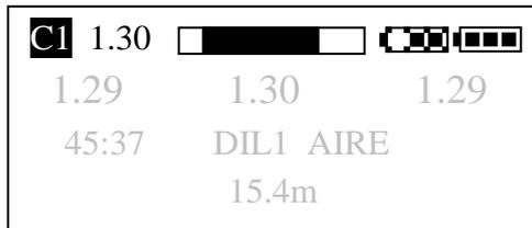
Cuando el Sofnolime sigue hacia arriba cogiendo temperatura, la pantalla se vuelve negra en esas zonas y se ve que la parte activa del absorbente se mueve de izquierda a derecha a través de la pantalla.
