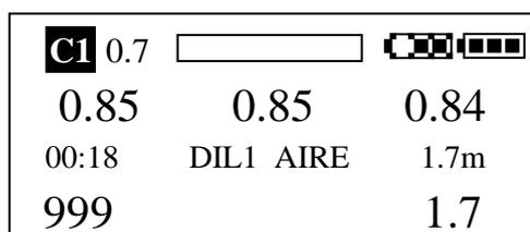
Las dos líneas superiores son las mismas que Modo inmersión - Superficie. La ppO<sub>2</sub> detectada por las células de Oxígeno se muestra en la parte central de la pantalla.
