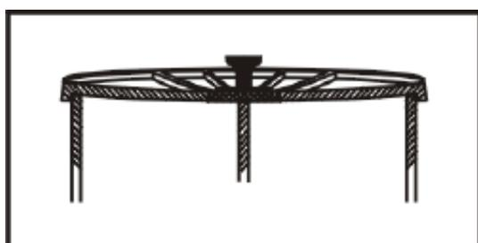
Si lo aprieta en exceso, la parte superior se puede deformar y puede no ser paralelo a los laterales. Si le sucediera, mandelo a la fabrica para su reparación.
