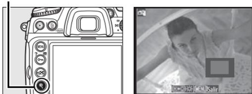
Cuando se amplíe la imagen que se vea a través del objetivo, aparecerá una ventana de navegación en la esquina inferior derecha de la pantalla. Utilice el multiselector para cambiar de marca de zona de AF.
