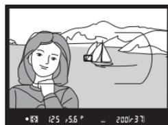
No modifique la distancia entre la cámara y el sujeto mientras el bloqueo del enfoque esté activado. Si el sujeto se mueve, enfoque otra vez para la distancia nueva.
