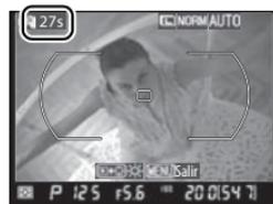
En los modos de exposición que no sean Manual, tape el visor con la Tapa del ocular DK-5 que se proporciona después de enfocar. De este modo se evita que la luz que entre a través del visor interfiera en la exposición.
