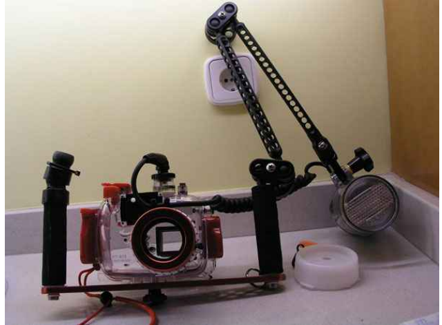
Sistema completo caja, pletina con asas, brazo articulado y flash con conexión TTL.
