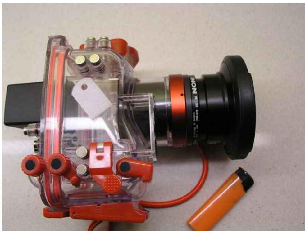
Vista superior de PT-015 con la UWL-100, con referencia de tamaño. Como se aprecia, el conjunto aún es manejable.
