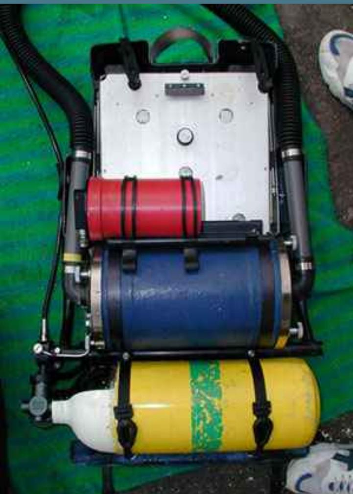
Bajo la cubierta de una de las poquísimas unidades civiles del Interspiro DCSC, podemos ver las partes generales de todo rebreather: una botella amarilla y verde de suministro de Nitrox, el filtro (en azul), la caja de inyección (en rojo) y bajo la tapa de aluminio, un único contrapulmón con forma de fuelle, las traqueas y la boquilla.
